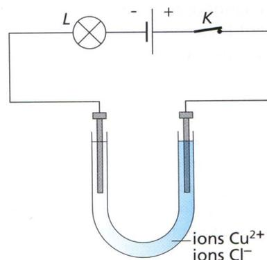
1. À la fermeture de l'interrupteur, la lampe s'allume. Que peux-tu en conclure pour la solution de chlorure de cuivre ?
